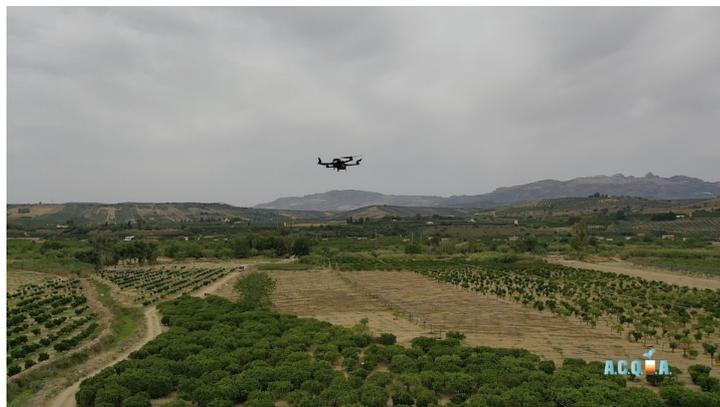
L'attività pilota è stata condotta su una ventina di aziende in diversi territori destinati all'agrumicoltura: le immagini sono state rilevate tramite speciali fotocamere multispettrali montate sul drone. I risultati indicano **potenzialità dell'uso di questa tecnologia per individuare problematiche connesse agli impianti di irrigazione**, consentendo di identificare, alla scala del singolo albero, eventuali disomogeneità dell'adacquamento.
