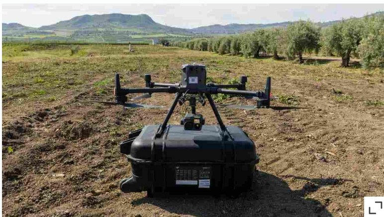
▲ Il drone che rileva lo stress idrico degli agrumeti
